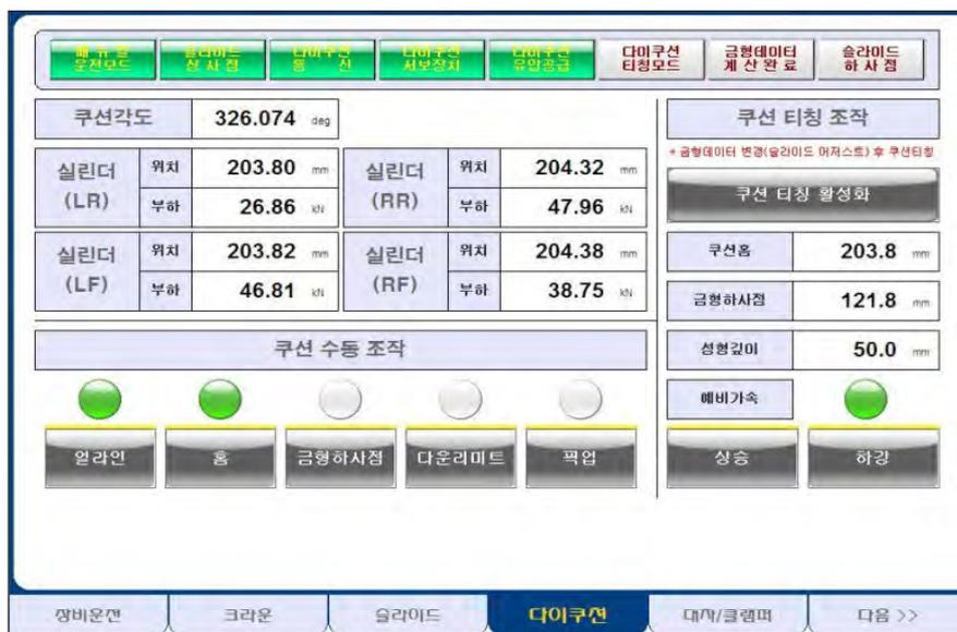
Mit intuitiv gestalteten Bildern erhalten die Bediener Zugang zu vielen wertvollen Daten wie den Status der Presse (z. B. Dämpfwinkel, Lage jedes Zylinders, Bewegungen der Presse und vieles mehr).
