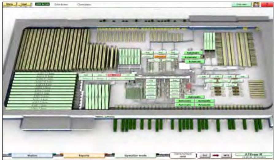
*Die gesamte Fördertechnik im Überblick: Sämtliche Abläufe im neuen Hochregallager von John Lewis werden mit zenon visualisiert und gesteuert.*
